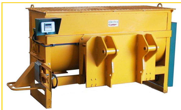
MH 1000 avec attache Télescopique et pesage électronique
